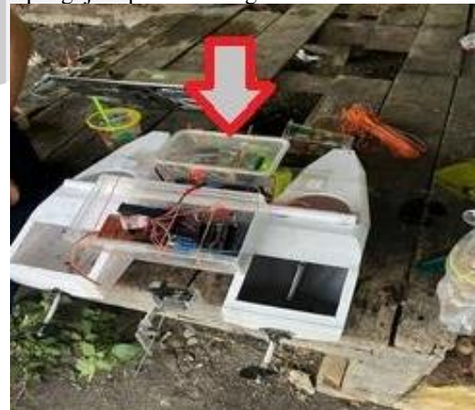
GAMBAR 10. Sensor pH dan Suhu Di letakan pada ASV
