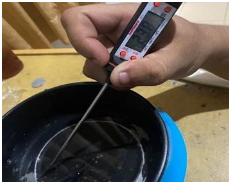
GAMBAR 8. Pengujian sensor suhu dan Termometer
