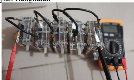
GAMBAR 5 (Pengujian Rangkaian Baterai Aluminium Udara)
