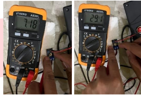
GAMBAR 10 Nilai Tiap Resistor dari Sensor Tegangan
