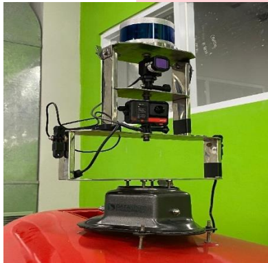
GAMBAR 5 Instalasi Thermal Camera FLIR Pada Mobil KLO
