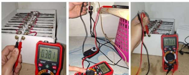
GAMBAR 23: HASIL PENGUJIAN PENGISIAN MODUL BATERAI ALUMINIUM
