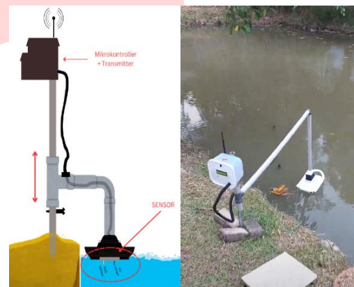
GAMBAR 6. Sistem Sensor dan Transmitter
