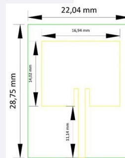
GAMBAR 3.4 DESAIN ANTENA SETELAH OPTIMASI
