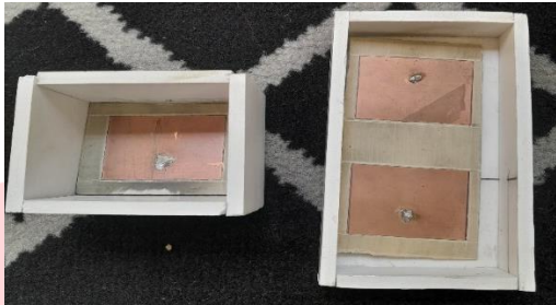
GAMBAR 3. 3 Realisasi Antena dengan Box Ukur
