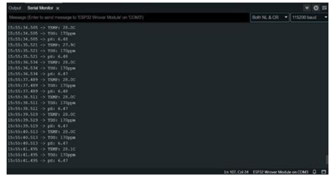
GAMBAR 3.1 Hasil Pengujian Pembacaan Sensor
