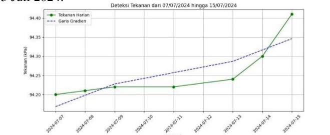
GAMBAR 8. Grafik hasil pengujian sensor BMP180
