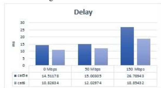
Gambar 4.4 Delay Kabel UTP cat5e dan cat6
