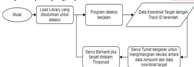
GAMBAR 19 (FLOWCHART CARA KERJA SISTEM SETELAH GUI DIHILANGKAN)
