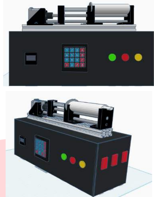
GAMBAR 3 (DESAIN 3D SYRINGE PUMP TAMPAK DEPAN DAN SAMPING KANAN)
