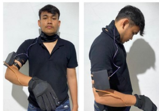
GAMBAR 4.2 CONTOH PENGGUNAAN ALAT PENDETEKSI KELELAHAN PADA PENGENDARA
