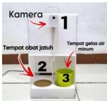
GAMBAR 4.2 Casing Kotak Obat Tampak Depan
