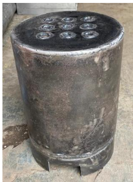
GAMBAR 3.6 boiler setelah pengelasan
