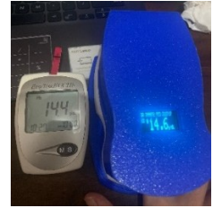
Gambar 7 Pengujian Perbandingan perangkat Hemoglobin Non-Invasif dengan Invasif
