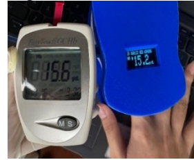
Gambar 7 Pengujian Perbandingan perangkat Hemoglobin Non-Invasif dengan Invasif
