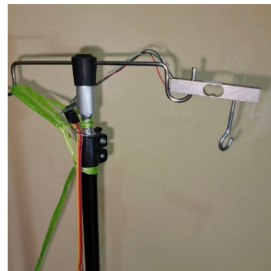
GAMBAR 11 (Sensor Load Cell pada Tiang Infus)
