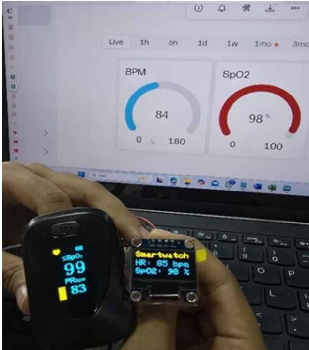
GAMBAR K (HASIL PENGUJIAN DENGAN PERBANDINGAN TAMPILAN PADA BLYNK DAN OLED)
