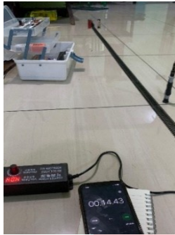
GAMBAR 9 (PENGUJIAN KECEPATAN LINIER MENGGUNAKAN 12 V)
