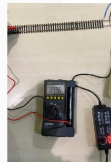
GAMBAR 7 (PENGUJIAN TEGANGAN PADA REL)
