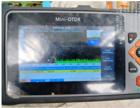
GAMBAR 8 (HASIL PENGUKURAN SPLICE LOSS DAN PANJANG KABEL DESA CINUNUK)
