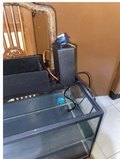
GAMBAR 4.2 IMPLEMENTASI SISTEM MONITORING DAN PEMBERIAN PAKAN OTOMATIS PADA AKUARIUM
