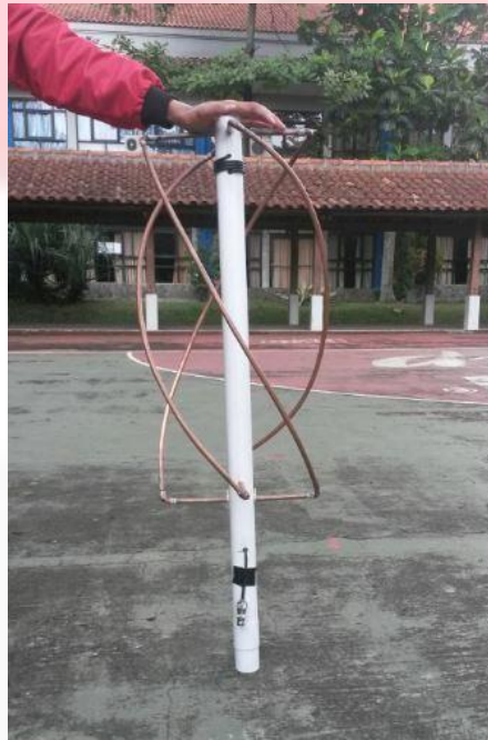
Gambar 4. Realisasi Antena Quadrifilar Heliks
