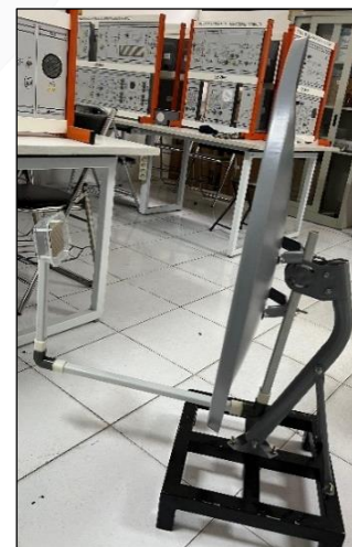
Gambar 4 Prototipe Antena Reflektor berbasis Feed E-Shaped MSA dengan DNG Metamaterial
