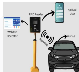
Gambar 1 Skema Umum Sistem RFID
