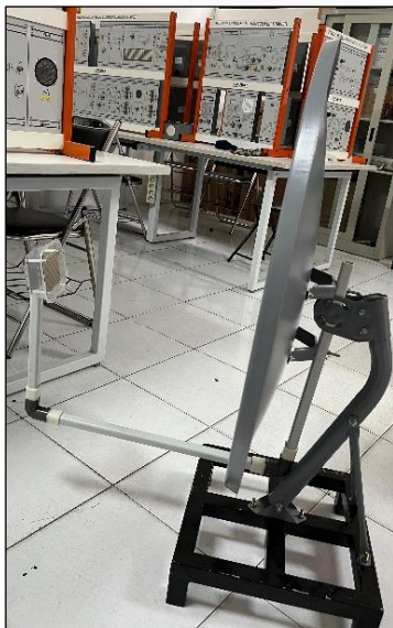
Gambar 6 Prototipe Antena Reflektor berbasis Feed E-Shaped MSA dengan DNG Metamaterial
