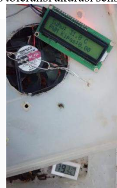
GAMBAR 19 (KALIBRASI SENSOR SUHU DHT 22 DENGAN HYGROMETER)
