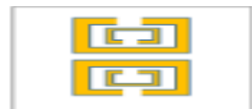
GAMBAR 2 (BENTUK SPLIT RING RESONATOR)
