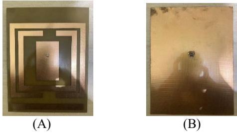
GAMBAR 9 (TAMPAK ANTENA DEPAN (A), DAN TAMPAK ANTENA BELAKANG (B))
