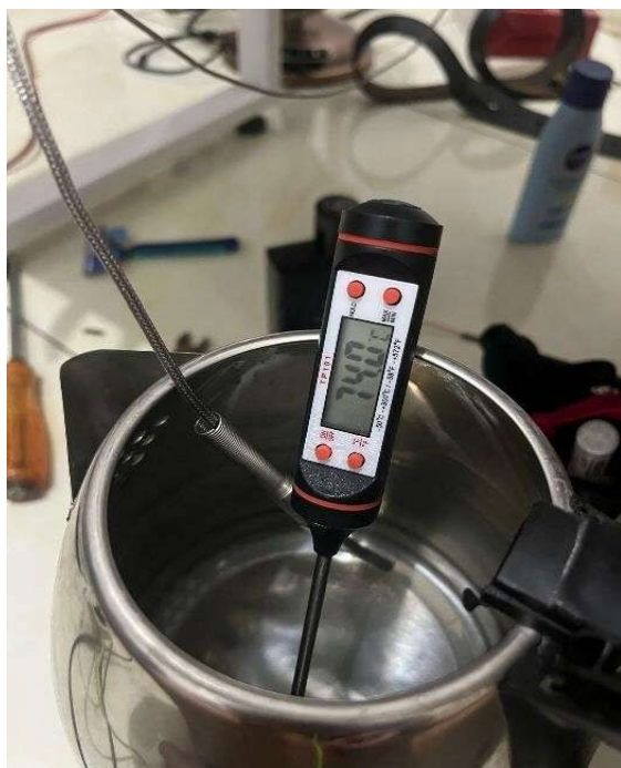
GAMBAR 1 kalibrasi thermocouple menggunakan thermometer
