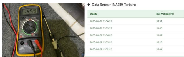
GAMBAR 7 Ujicoba Sensor INA219
