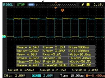
Gambar 4.1 Dua sinyal PMW dari port mikrokontroler ATmega 8535
