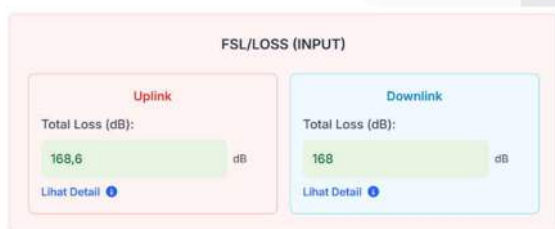
GAMBAR 7 NILAI PATH LOSS UNTUK FREKUENSI UPLINK 3300 MHz & FREKUENSI DOWNLINK 3100 MHz
