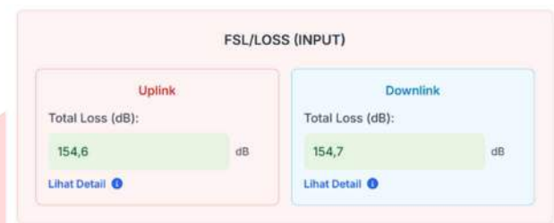
GAMBAR 9 NILAI PATH LOSS UNTUK FREKUENSI UPLINK 923 MHz & FREKUENSI DOWNLINK 925 MHz
