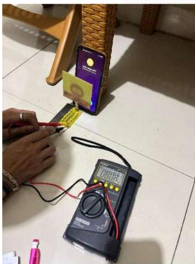
GAMBAR 14 (Pengujian Rectenna dengan handphone )
