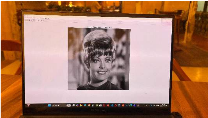
Gambar 5. Simulasi serangan screen-shooting. Gambar ber-watermark ditampilkan di layar laptop dan diambil ulang menggunakan kamera digital yang dipasang pada tripod pada jarak tertentu. Pengaturan ini menghasilkan distorsi praktis seperti lengkungan perspektif, interferensi moire', dan variasi iluminasi.
