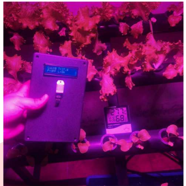
GAMBAR 6 Hasil Pengujian Akurasi Sensor DHT22
