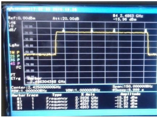
Gambar 3.7 Hasil output optimasi rangkaian LNA pada spectrum analyzer
