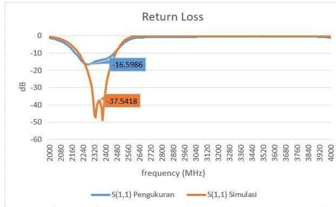
Gambar 8 Hasil perbandingan simulasi dan pengukuran return loss
