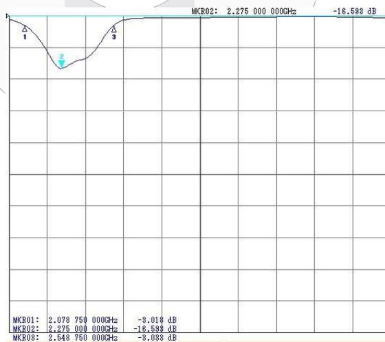
**Gambar 7 Hasil pengukuran return loss untuk BPF**
