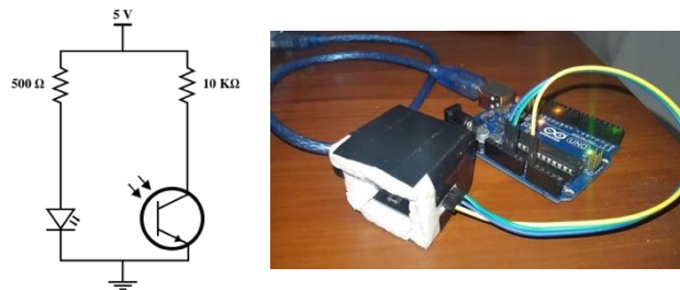
Gambar 4 Rangkaian sensor dan realisasi alat rancangan
