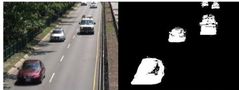
Gambar 3.3. Hasil GMM warna hitam untuk background dan warna putih untuk foreground
