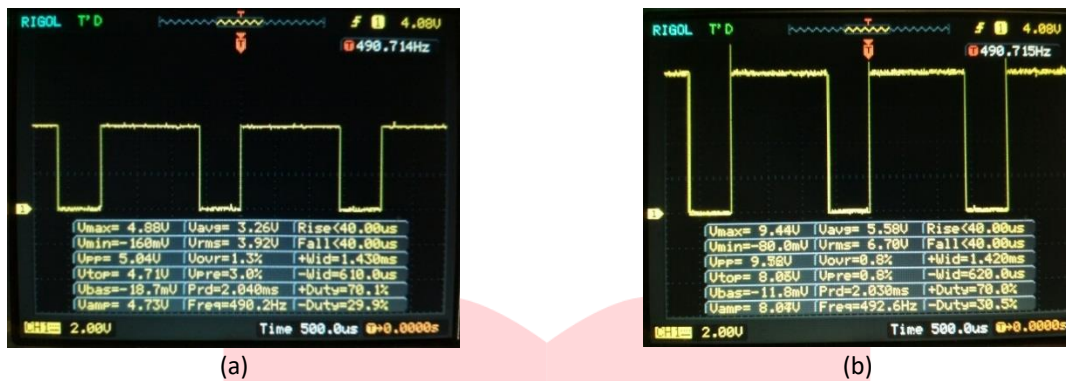
Gambar 4.1. (a) Sinyal pwm yang di dihasilkan Arduino Nano dengan duty cycle sebesar 70% Dan (b) sinyal pwm yang di dihasilkan driver mosfet TLP250 dengan duty cycle sebesar 70%
