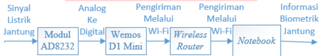
Gambar 1 Diagram Blok Sistem Pengiriman Data
