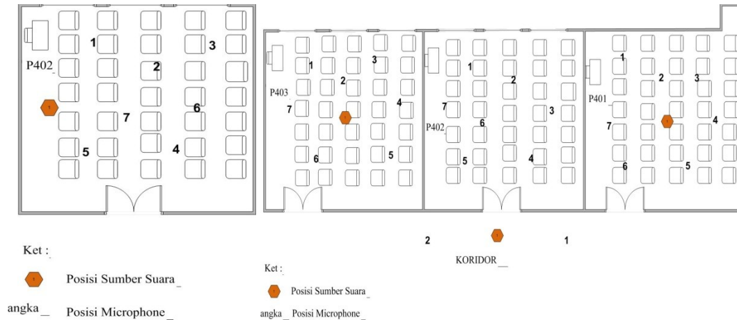
(a) (b) Gambar 2 Denah titik pengukuran (a) medan suara (b) insulasi suara
