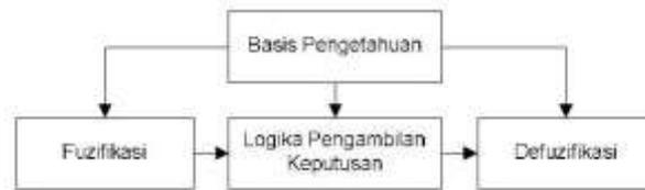
Gambar 2 Konfigurasi Dasar *Fuzzy Logic Controller*
