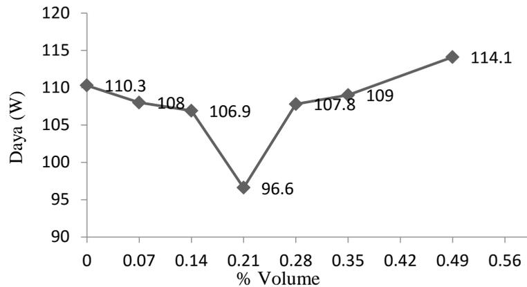
Gambar 3.5 Grafik daya kompresor terhadap konsentrasi nanopartikel.
