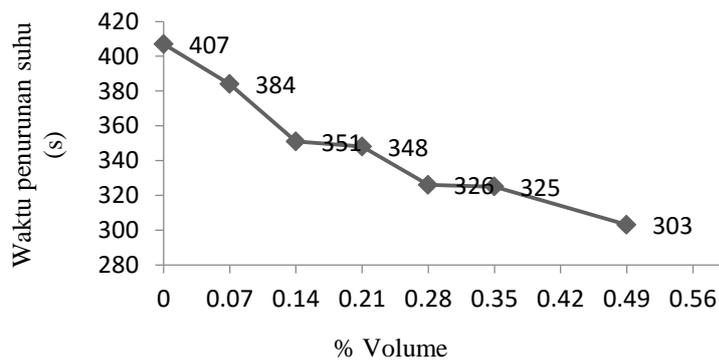
Gambar 3.5 Grafik waktu penurunan suhu terhadap konsentrasi nanopartikel.
