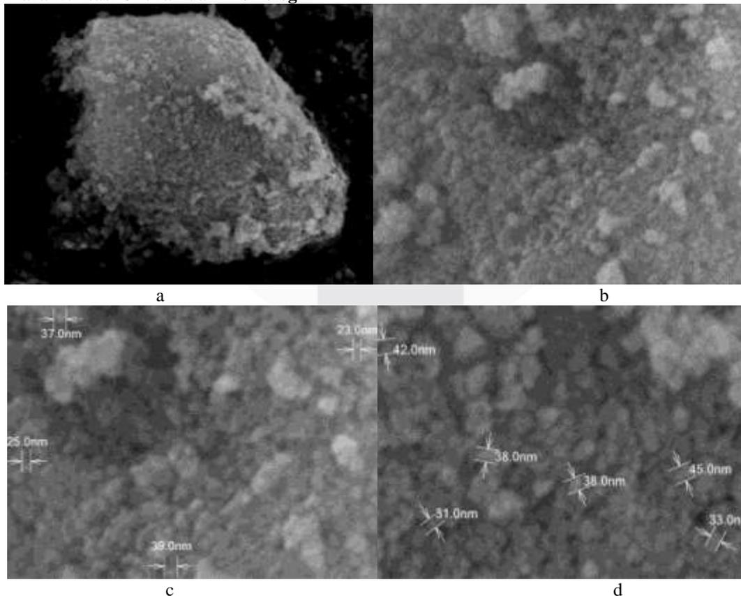
Gambar 3.2 Morfologi nanopartikel Al<sub>2</sub>O<sub>3</sub> pada pembesaran yang berbeda: (a) 20000 kali; (b) 50000 kali; (c) 80000 kali; (d) 80000 kali dengan daerah yang berbeda.
