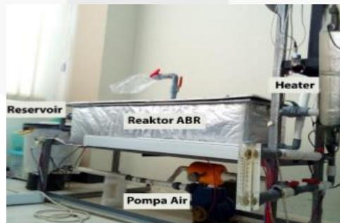
Gambar 2. 1. Sistem penghasil hidrogen ABR (*Anaerobic Baffled Reactor*)
