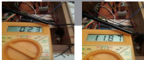
Gambar 7 (a.kiri) Tegangan Keluaran Driver TIP120 Saat Belum Diberikan Tegangan dari Arduino, (b.kanan) Tegangan Keluaran Driver TIP120 Saat Telah Diberikan Tegangan dari Arduino
