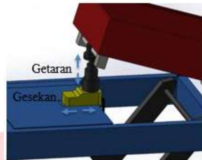
Gambar 17 Interaksi *Incidental* pada *Table dan Hydraulic*.
