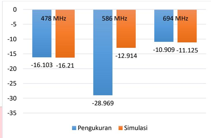
Gambar 4 Perbandingan Simulasi dan Pengukuran Return Loss
