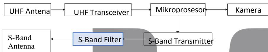
Gambar 1. Blok Komunikasi Satelit Nano Dan Posisi Filter *S-Band* Filter Pada Satelit Nano[2]
