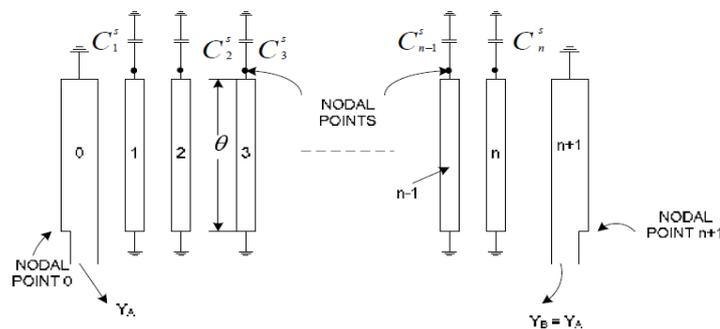
Gambar 2. Susunan Resonator Pada Filter *Comblin*[4]
