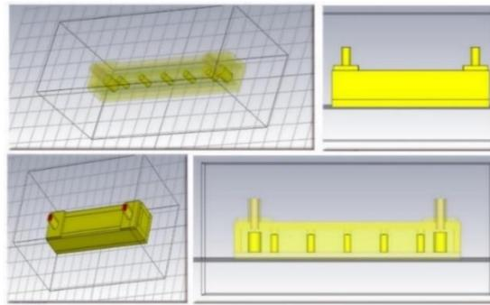
Gambar 4 Optimasi Filter *Comblaine Cavity* Menggunakan Aplikasi
