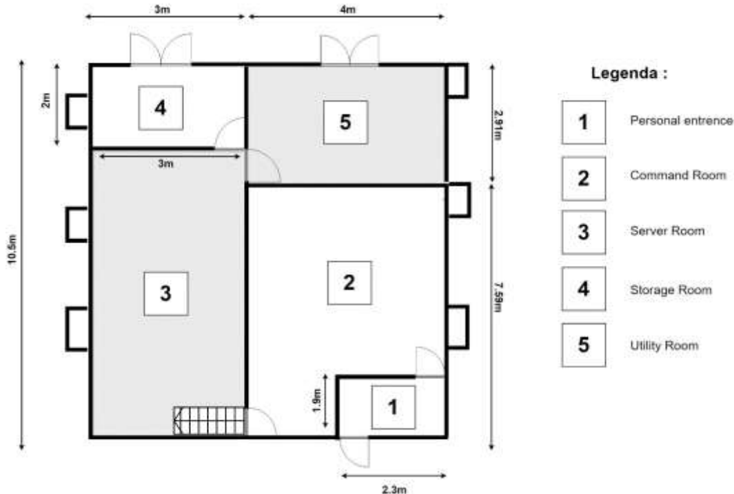
Gambar 4 Denah Usulan Ruangan Data Center
